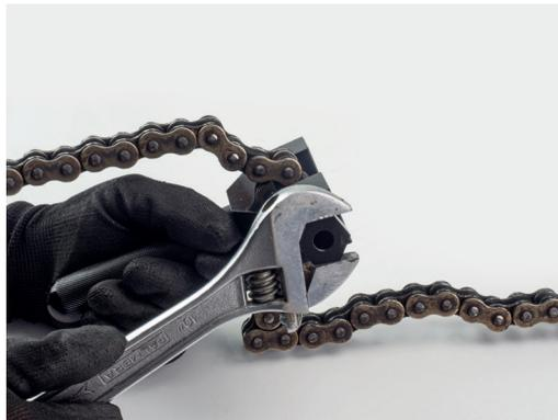
**2** Kette einspannen und Druckschraube mit passendem Schraubenschlüssel anziehen
