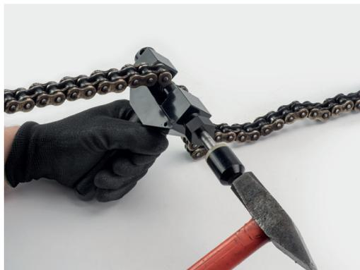
**3** Dorn einsetzen und Nietstift mithilfe eines Hammers herausschlagen.
