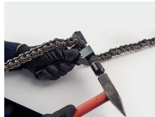
**6** Bolzen durch Druckschraube führen und Kettenstift mithilfe eines Hammers vernieten. Bolzen um 90° drehen und zweite position vernieten, sodass die Niete an allen seiten abgerundet ist.
